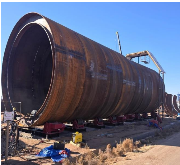
ШШХ буюу пропан, бутан хадгалах даралтат хэвтээ савны үйлдвэрлэл
